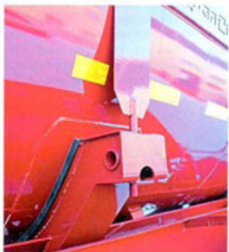
Крепление емкости в ложементах рамы при помощи стяжных лент
