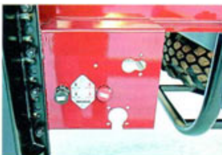
Пульт пневмоуправления стояночной тормозной системой
