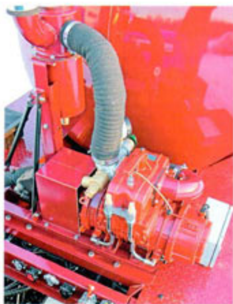
Насос Juror PNR 122 шиберный, с воздушным охлаждением, итальянского производства
