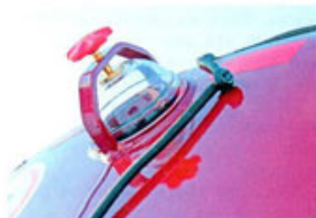
Специальный смотровой люк облегчает контроль за содержимым цистерны
