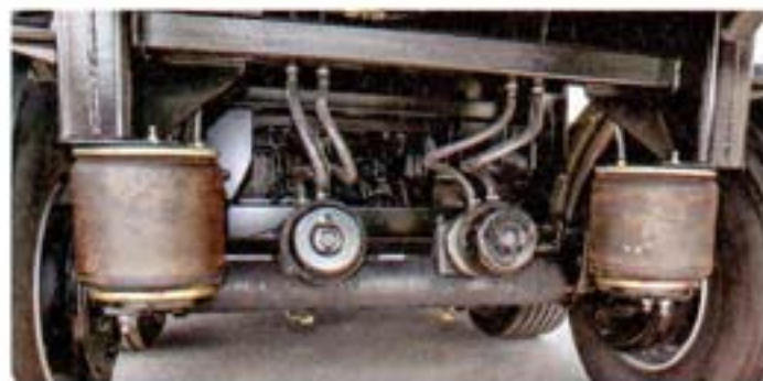
Одно из достоинств пневмоподвески – равномерность загрузки осей, что очень важно для 44-тонного полуприцепа
