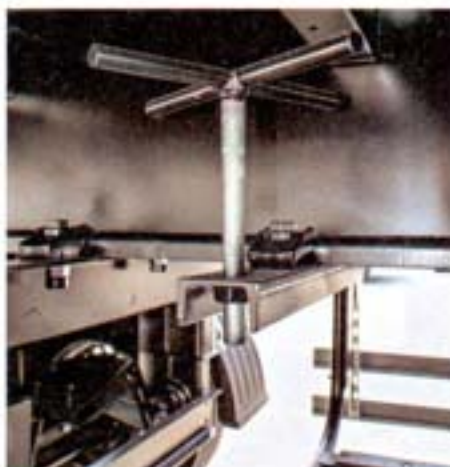
Под платформой съемные борта фиксируют специальным зажимом
