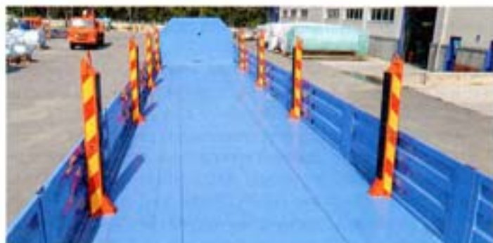
В сдвинутом состоянии коники расположены внутри кузова и защищают борта от повреждений тяжелым грузом
