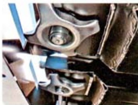
Замки-твистлоки притягивают контейнер к платформе мощными гайками
