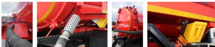
Вакуумные автоцистерны оборудуются **напорно-всасывающим рукавом** с накидной гайкой и заборным фильтром, защищающим от попадания крупных механических примесей. В транспортном положении свободные концы рукава укладываются в **открытые пеналы**, а середина фиксируется цепью к кронштейну на заднем днище. В рабочем положении рукав крепится к заборному лючку.
