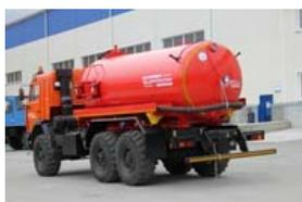
Вакуумная автоцистерна может быть изготовлена с **открывающимся днищем**. Вариант исполнения определяется техническим заданием и условиями эксплуатации. Открывающееся днище крепится к корпусу цистерны на шарнирных соединениях. Запор днища осуществляется винтовыми фиксаторами. Дополнительная герметичность вакуумной цистерны обеспечивается уплотнителем.
