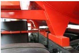
Емкость, ложементы и лонжероны объединены в единую конструкцию. При установке на раму предусмотрена резиновая прокладка-демпфер. Цистерна фиксируется к раме транспортного средства при помощи стремянок с пружинными компенсаторами. Данный вариант крепления позволяет исключить повреждение цистерны при скручивании рамы транспортного средства во время движения по пересеченной местности.
