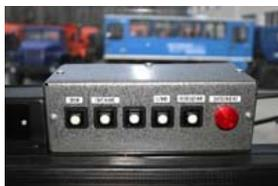
Вакуумная машина оснащается **звуковой и световой сигнализацией**, срабатывающей при достижении предельного уровня жидкости в цистерне. Индикатор световой сигнализации располагается на пульте управления внутри кабины водителя, где оператор отключает насос и останавливает заполнение цистерны. Также наша компания может оборудовать вакуумную машину **системой автоматического отключения насоса**.
