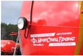
Для безопасности и удобства работы в условиях плохой видимости вакуумные машины «УралСпецТранс» оборудуются **фарой-прожектором**, установленным на заднем днище цистерны.
